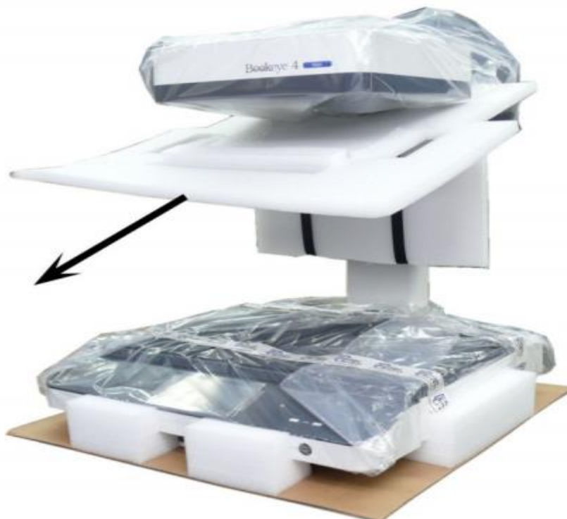
Hình 3: Nhựa bọt mát treo dưới đầu camera
