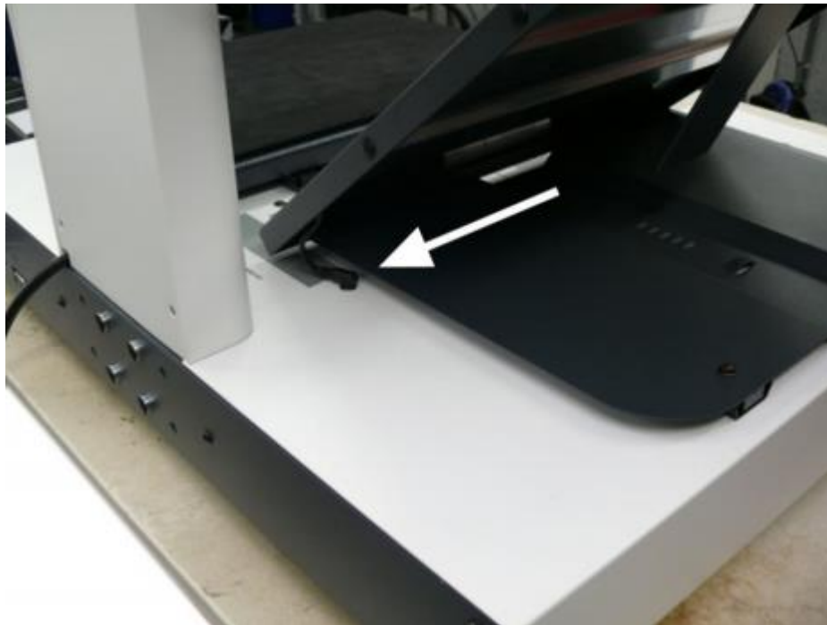
Hình 32: Nút cắm 3.5" bên dưới tấm số cái nôi
