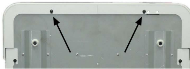
Hình 24: Phía dưới của bảng điều khiển phía trước Bookeye 4 V3
