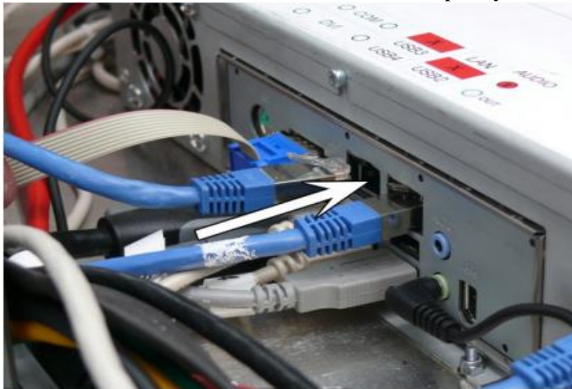
Hình 64: Kết nối cáp mạng LAN
