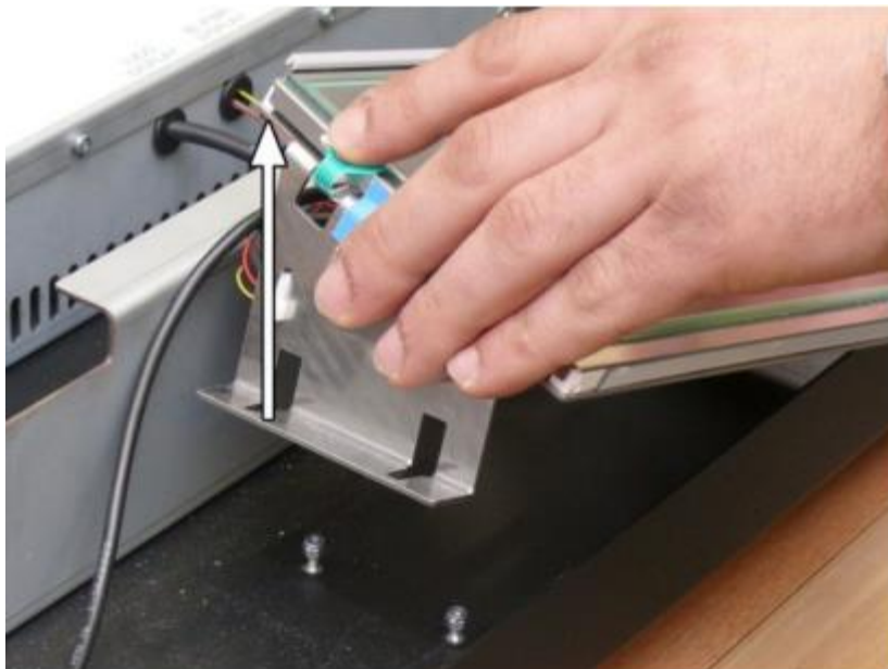
Hình 55: Nâng module màn hình cảm ứng Cuối cùng tháo cáp đến màn hình ra khỏi hộp máy tính.
