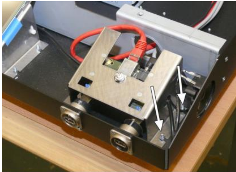
Hình 57: Vị trí ốc ở bên phải ... Sau đó nối lỏng hai ốc hình lục giác ở phía bên trái của trục kim loại.
