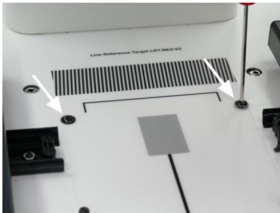
Hình 33: Vít gắn cố camera
