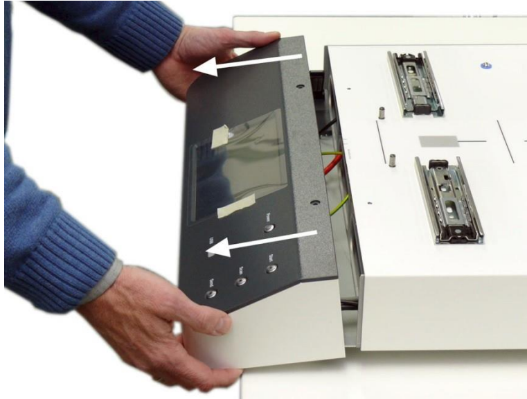
Hình 25: Loại bỏ bảng điều khiển phía trước
