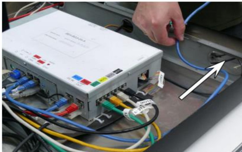
Hình 65: Cáp mạng LAN thông qua khe hình bầu dục
