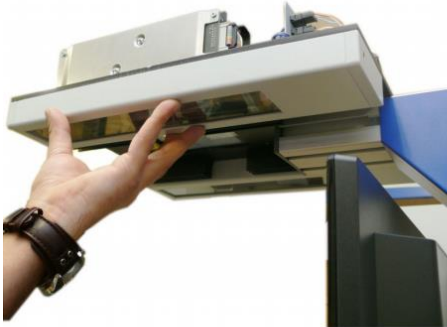
Hình 107: Giữ mặt dưới hộp đèn không cần chạm vào tấm kính
