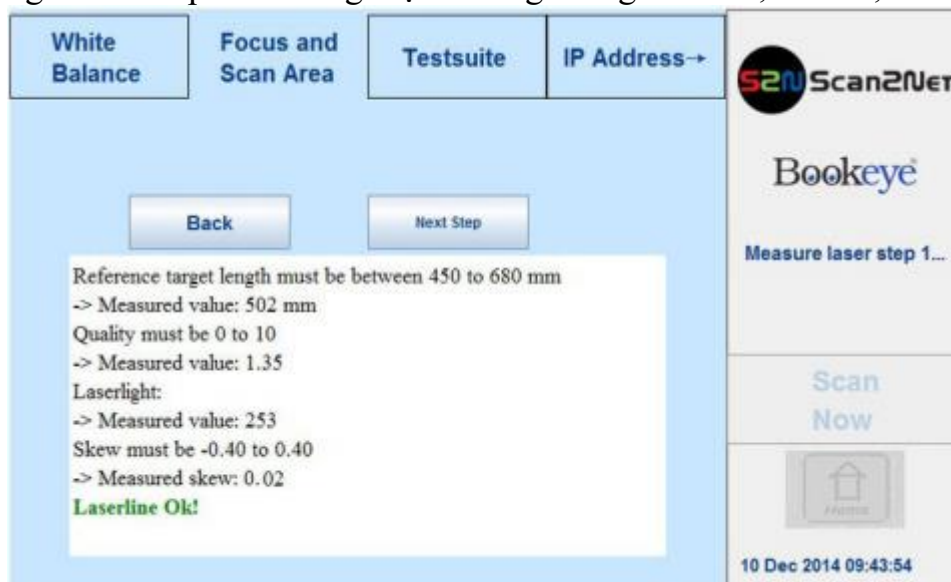
Hình 92: Kết quả trình tự kiểm tra laser
