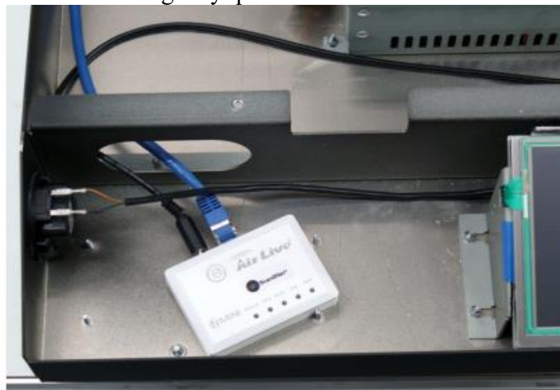
Hình 68: Vị trí mô-đun WLAN trong bảng điều khiển phía trước
