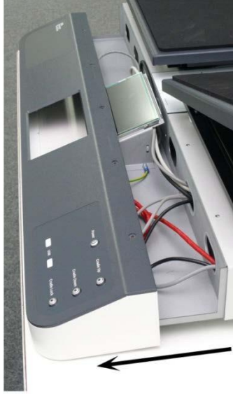
Hình 23: Bảng điều khiển phía trước tách ra từ hộp
