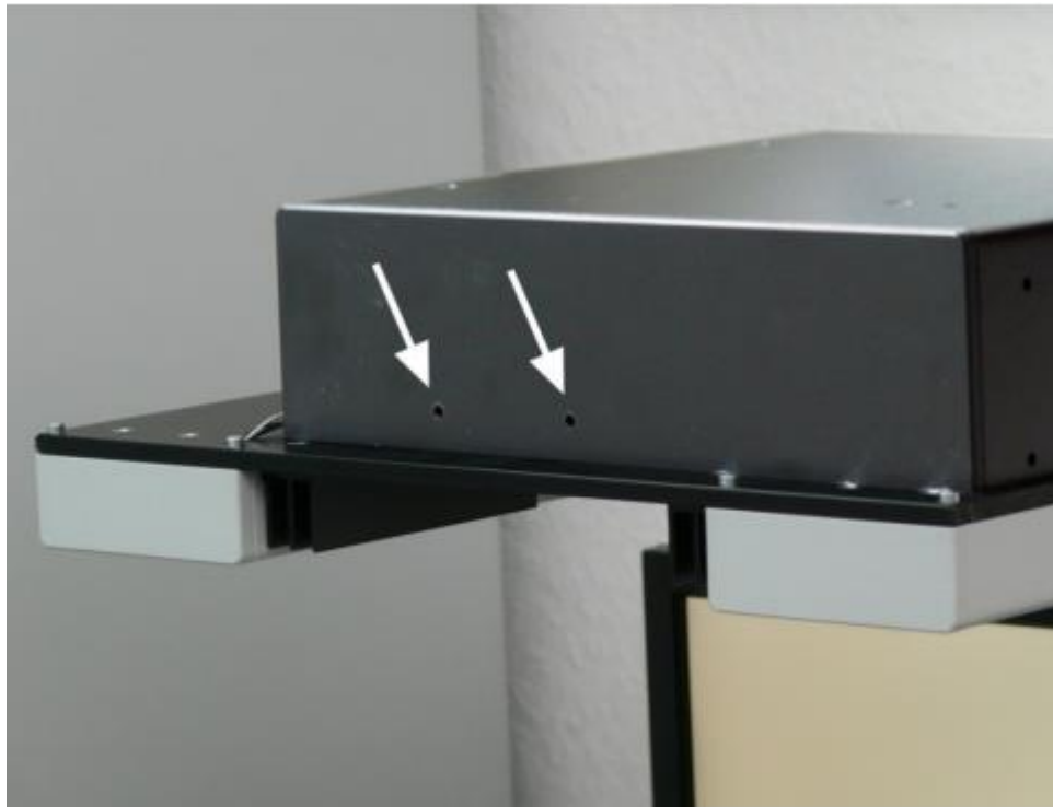
Hình 93: Lỗ khoan để điều chỉnh mô-đun bằng laser
