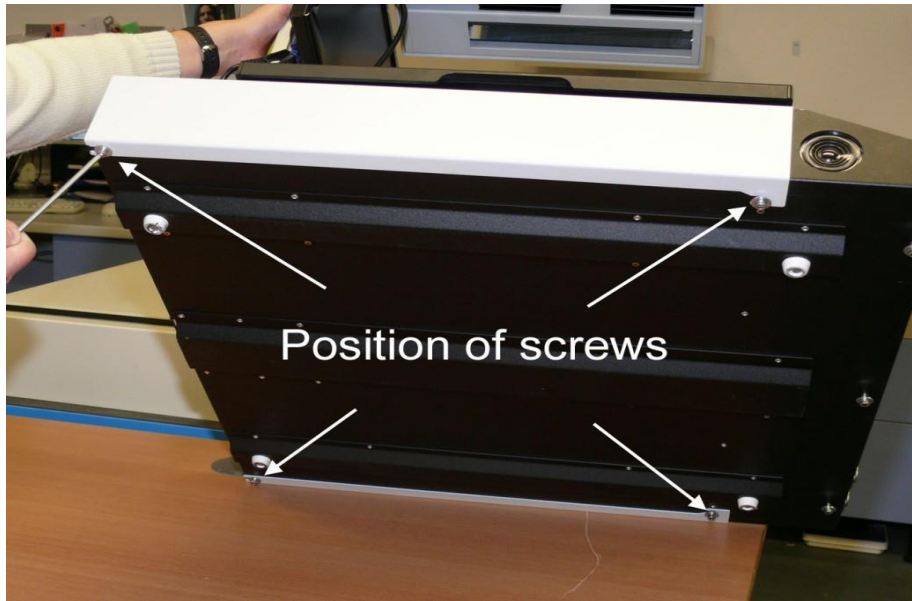
Hình 27: Vị trí 4 con vít ở vị trí phía dưới cùng
