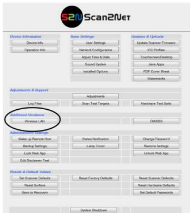
Hình 69: Cài đặt Module WLAN từ trình duyệt
