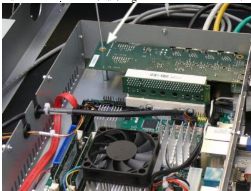
Hình 41: Vít giữ card điều khiển
