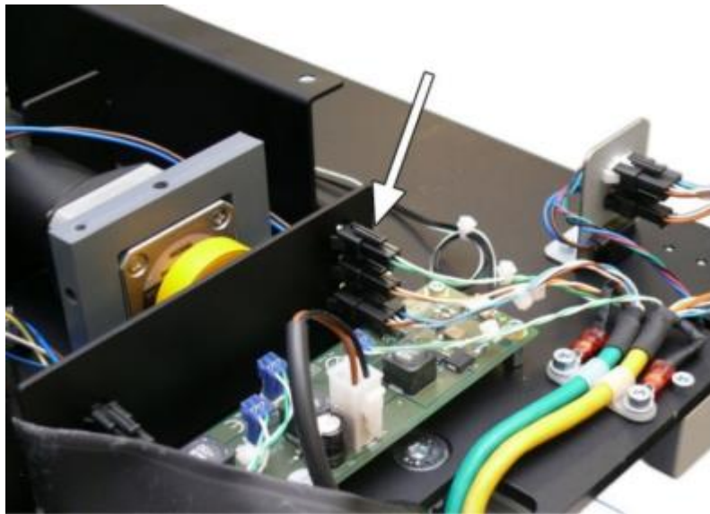
Hình 74: Khung kim loại nơi có kết nối điện cho đèn Laser
