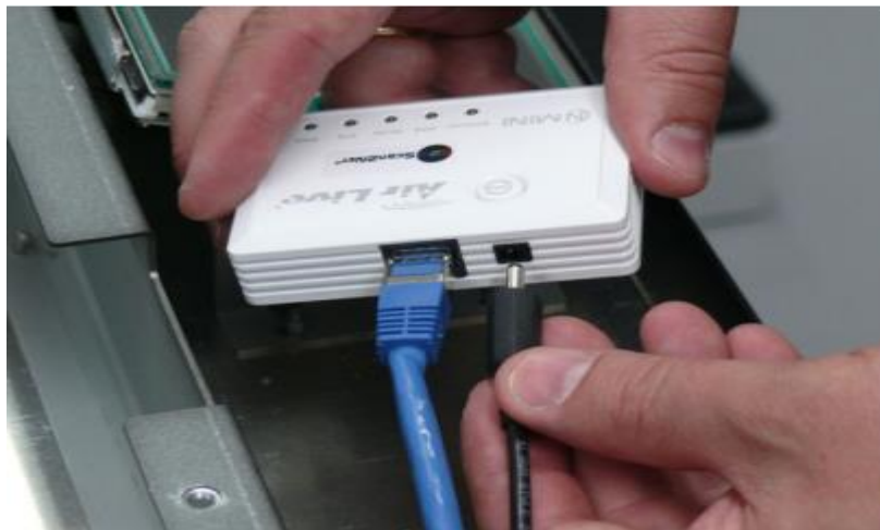
Hình 67: Cấp điện cho WLAN
