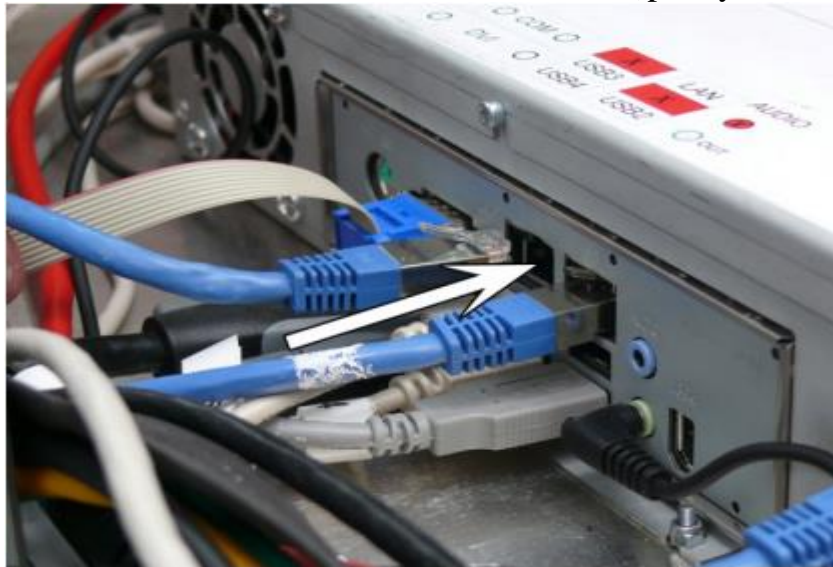
Hình 64: Kết nối cáp mạng LAN
