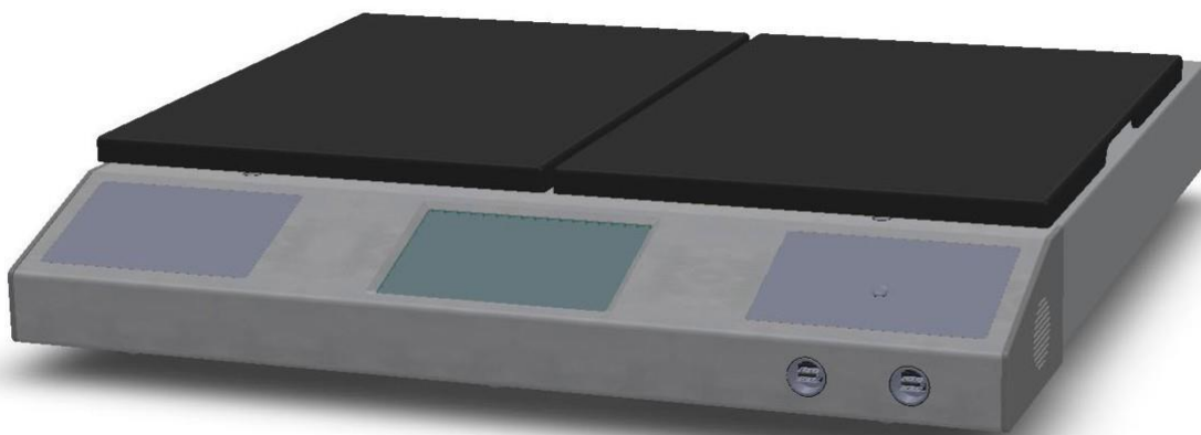
Hình 8: Đơn vị cơ sở không có cổ và đầu camera
